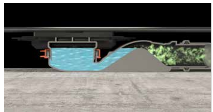
Sifone antidore permanente grazie alla forma sinusoidale
